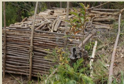
Tronçons de bois et structure du four servant à la fabrication du charbon de bois
